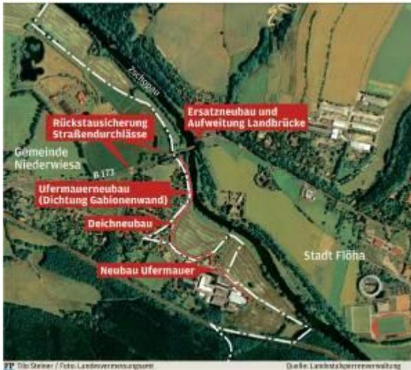
Zum Schutz der Ortslage Niederwiesa wurde im ersten Schritt die Brücke der Bundesstraße B 173 durch ein neues Bauwerk mit ausreichendem Querschnitt für den Hochwasserabfluss errichtet. Anschließend folgen nun Hochwasserschutzmaßnahmen zum Schutz der vorhandenen Bebauung Deich- und Mauerabschnitte entlang der Zschopau. Dafür werden Mittel des Europäischen Fonds für Regionale Entwicklung (EFRE) und Landesmittel investiert.
