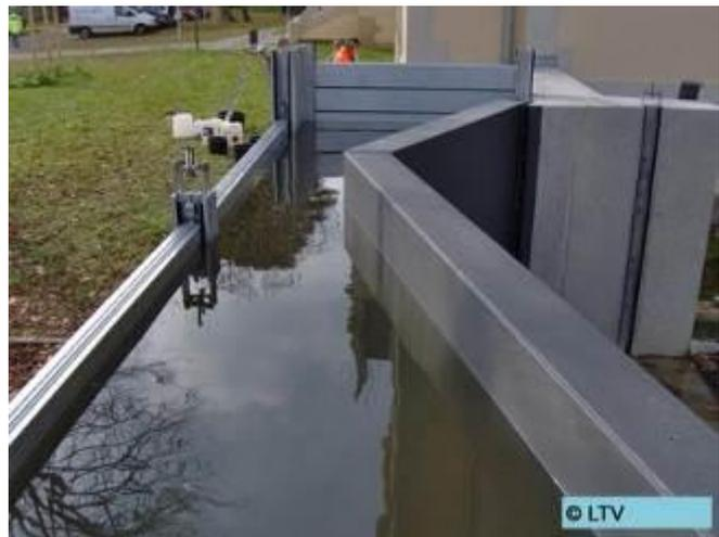
An der Polizeidirektion (Amtshauptmannschaft) wird eine Dichtheitsprobe der Hochwasserschutz Elemente durchgeführt.
