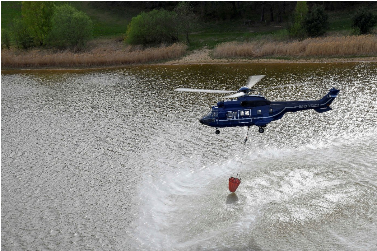
Bild 8: Löschwasseraufnahme einer AS 332 L1 der Bundespolizei mit einem Löschwasseraußenlastbehälter an einer Talsperre (Bundespolizei, 2021 [9]).
