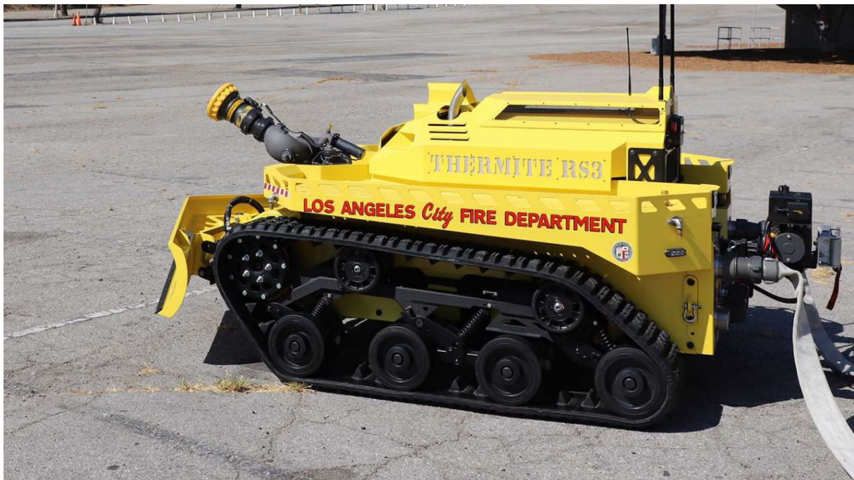
Bild 68: Ferngesteuertes Waldbrandeinsatzfahrzeug des Typs Thermite RS3 des Los Angeles Fire Department (Howe & Howe, 2021 [63]).
