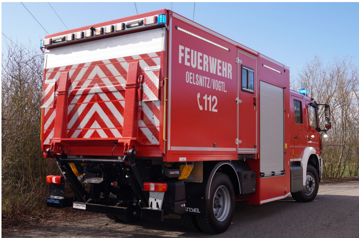
Bild 42: GW Logistik 2 der Freiwilligen Feuerwehr Oelsnitz, Vogtlandkreis. Der technische Aufbau dieses Fahrzeuges entspricht im Wesentlichen der Konzeption des GW Logistik 2 Mobile Maintenance Base (GW-L2 MMB) zur Unterstützung und Versorgung
