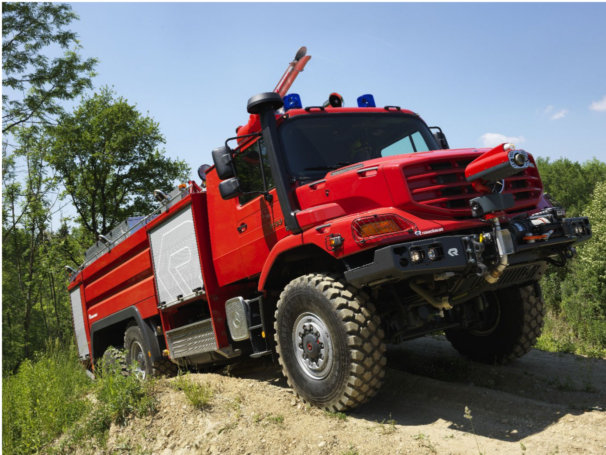
Bild 36: Geländegängiges GTLF 10 (6x6) als Bestandteil des neuen Katastrophenschutz-Löschzuges Waldbrand (Rosenbauer, 2020 [40]).
