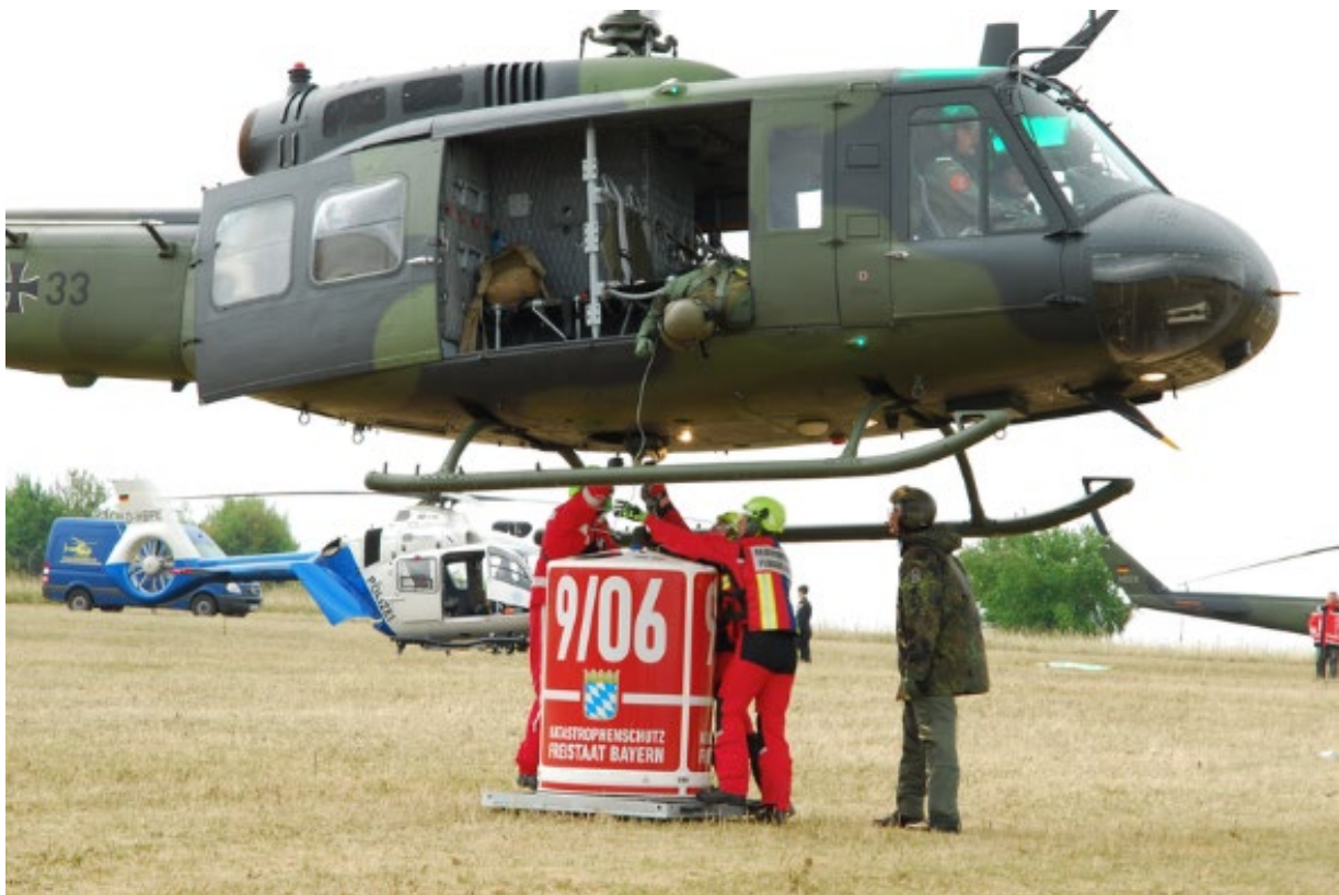
Bild 54: Flughelfer im Einsatz. Fachgerechte Befestigung eines Löschwasseraußenlastbehälters an einer Bell UH-1D (Scheller, 2018 [49]).
