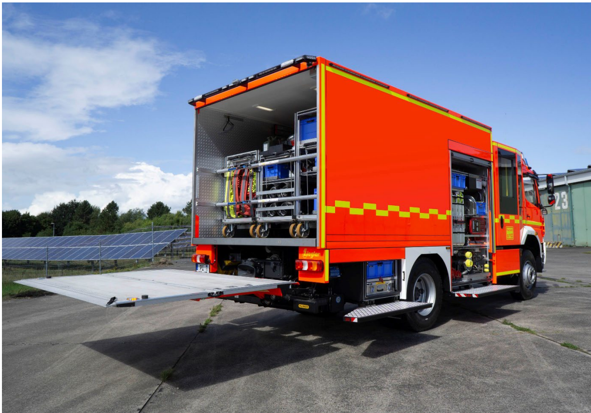
Bild 37: GW Logistik 2. Auf dem Bild erkennbar ist die Verlastung von Einsatzmitteln in Rollcontainern auf der Ladefläche, wodurch sich für das Einsatzfahrzeug neben der Wirtschaftlichkeit eine hohe Flexibilität hinsichtlich der Beladung und Nutzung für verschiedenste Aufgaben ergibt (Albert Ziegler GmbH, 2021 [41]).
