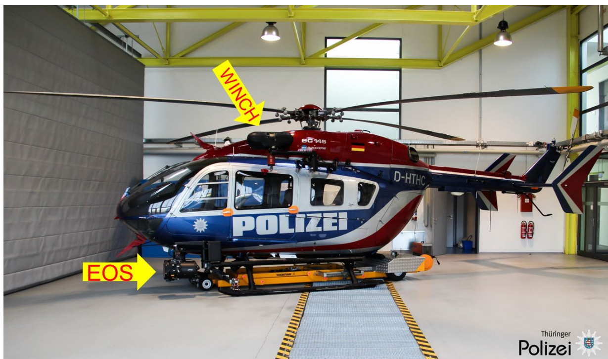
Bild 25: Polizeihubschrauber der Landespolizei Thüringen mit EOS (Elektro-optische Systeme) und Winde (engl.: Winch) (Polizei Thüringen, 2020 [34]).
