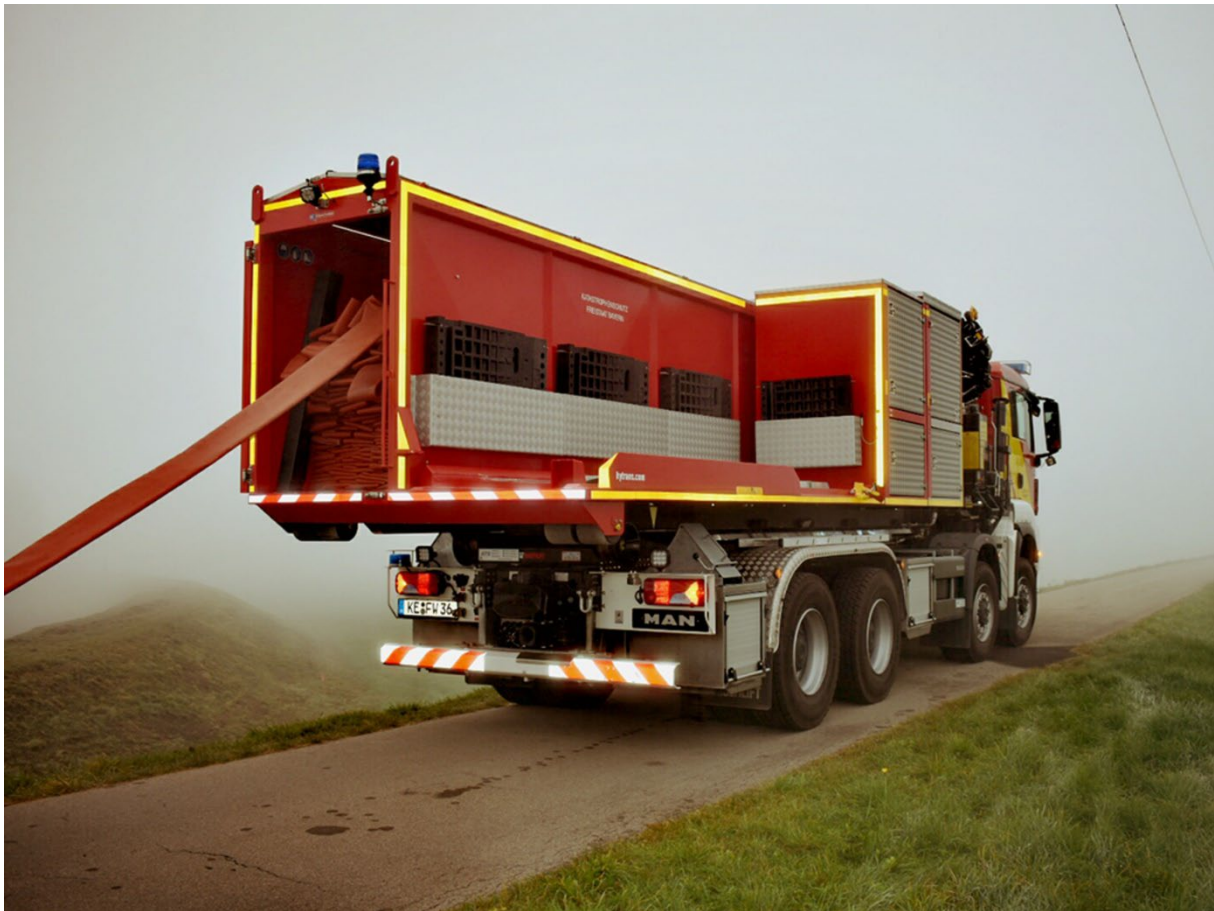
Bild 69: Das Hochleistungsfeuerlöschsystem (HFS) des Freistaates Bayern zur Förderung von Löschwasser (FF Kempten (Allgäu), 2021 [64]).
