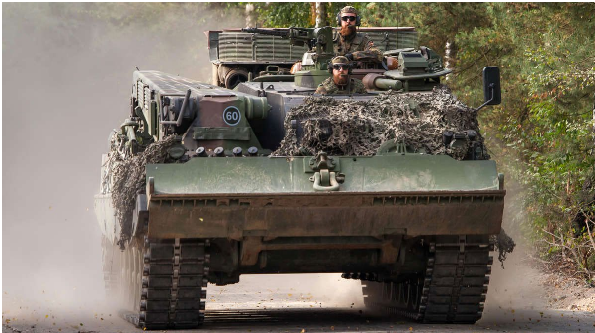
Bild 10: Bergepanzer „Büffel“ der Bundeswehr. Die Spillwinde des Fahrzeuges kann mit zwei Umlenkrollen versehen bis zu 105 t Zugkraft aufbringen. Durch den ballistischen Schutz ist das Fahrzeug auch in Kampfmittelverdachtsflächen einzusetzen (Dorow, 2021 [11]).
