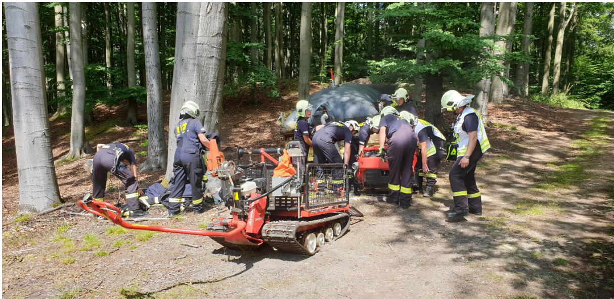
Bild 44: Deichselgeführtes Raupenfahrzeug der FF Ottendorf (Lkr. SOE) zum Transport schwerer Lasten in unwegsamem und mit Fahrzeugen der Feuerwehr nicht erreichbar Gelände (Schneider, 2020 [47]).
